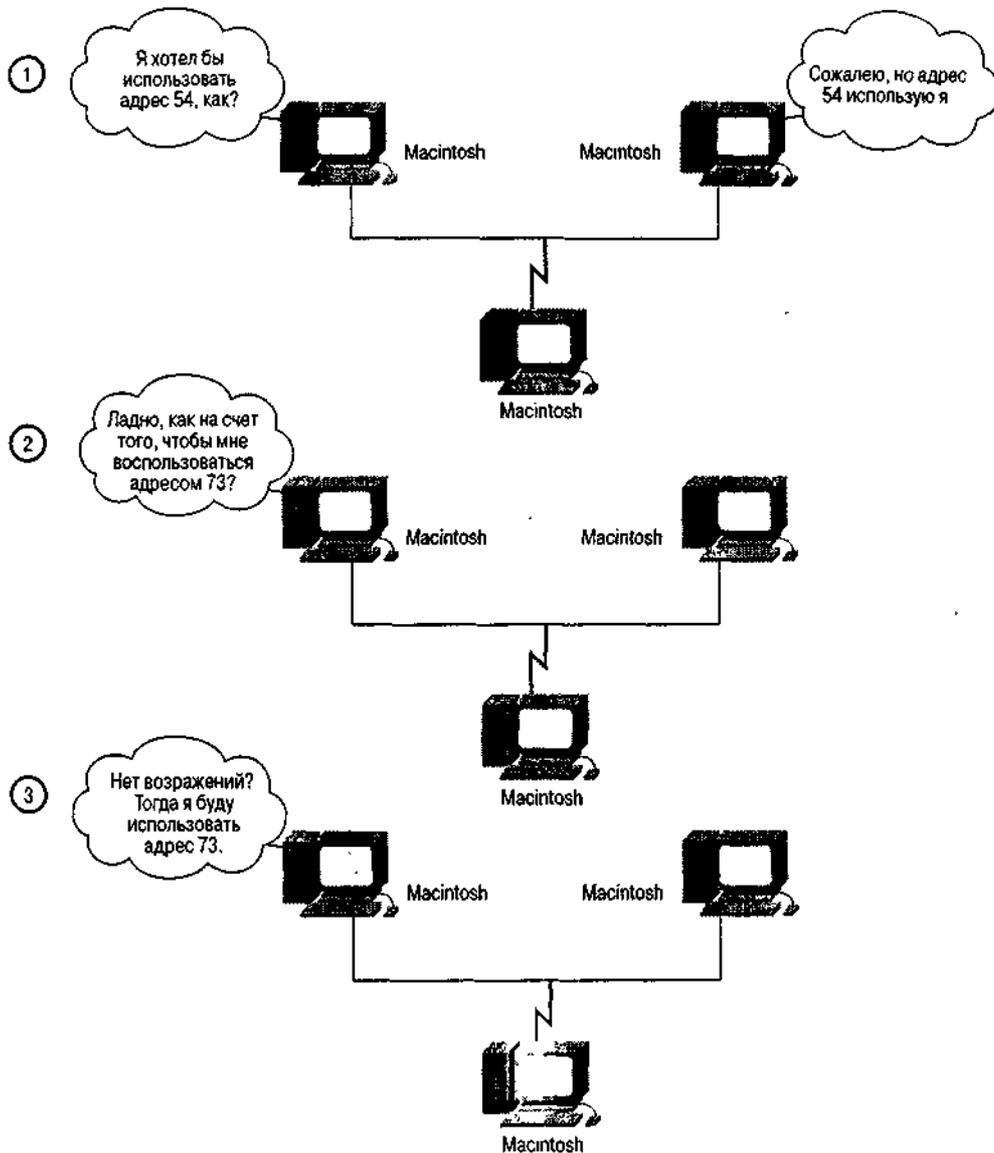
Рис. 5.2. Процесс выбора адреса узла в протоколе AppleTalk
