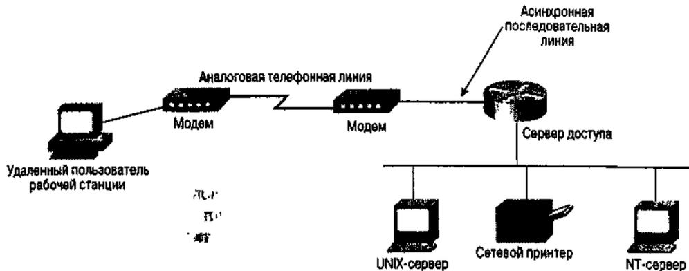
Рис. 4.9. Удаленный доступ по коммутируемым каналам к серверу доступа через модемы
