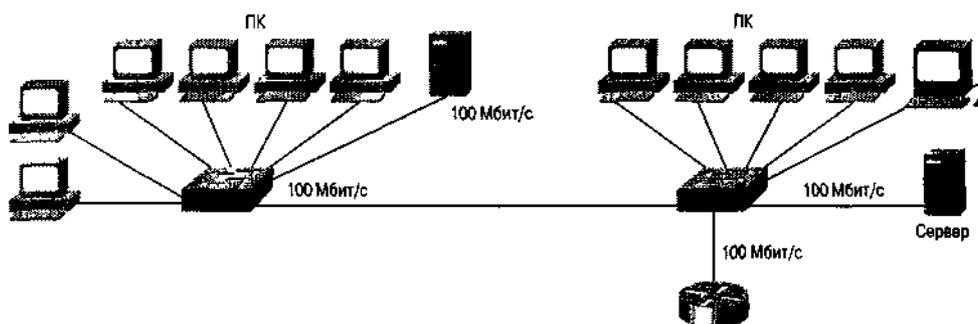
Рис. 1.5. Структурная схема малой сети с использованием коммутаторов
