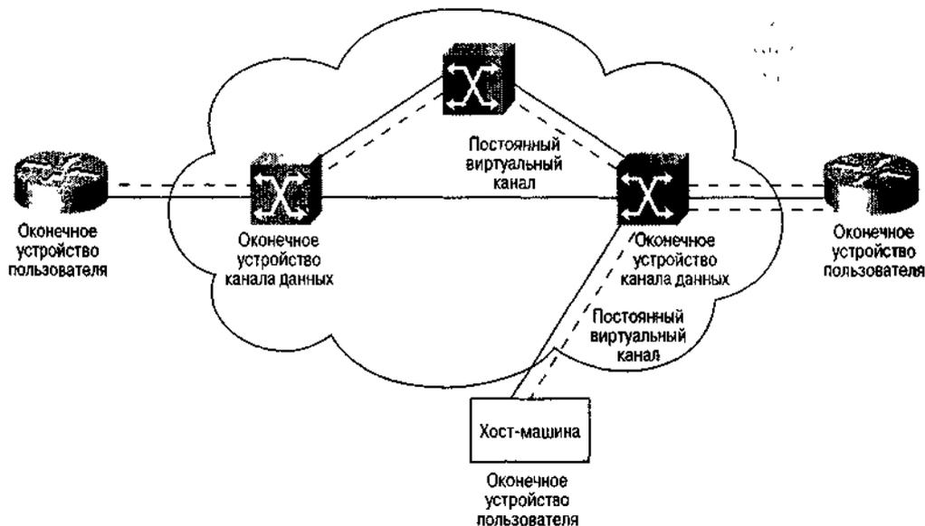
Рис. 3.7. Пример сети Frame Relay, использующей постоянные виртуальные каналы
