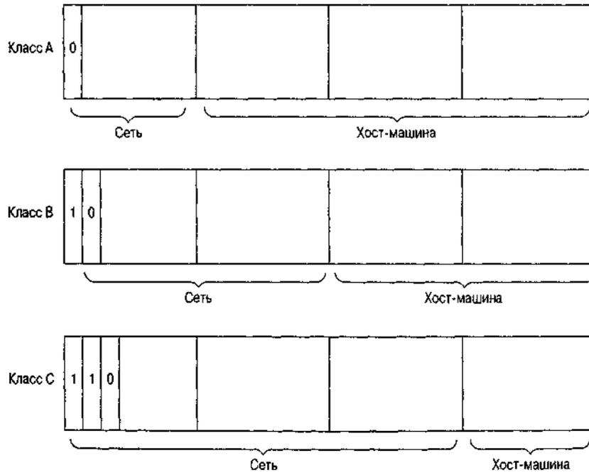
Рис. 4.1. Структура адресов классов А, В и С
