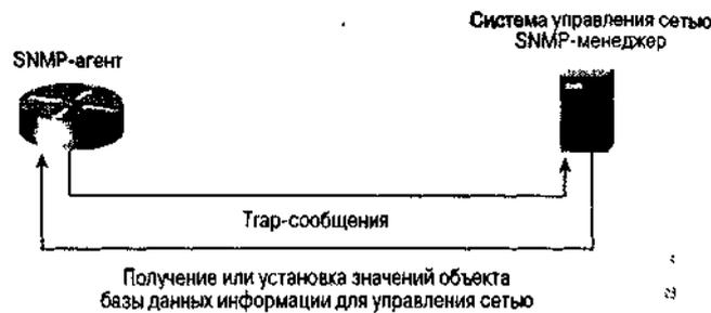
*Рис. 7.2. В соответствии с протоколом управления сетью менеджер запрашивает и выполняет установки относительно информации в базе данных управления сетью, а агент посылает менеджеру захваченные сообщения, которые содержат информацию о событиях в устройстве*
