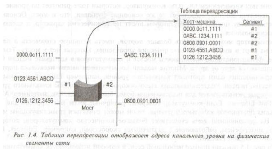
Простейшим мостом является *прозрачный мост*, который способен обрабатывать соединение только с одинаковыми протоколами канального уровня. *Инкапсулирующие* и *транслирующие* мосты можно рассматривать в качестве прозрачных мостов, которые обладают дополнительными функциями, позволяющими взаимодействовать различным протоколам канального уровня.
