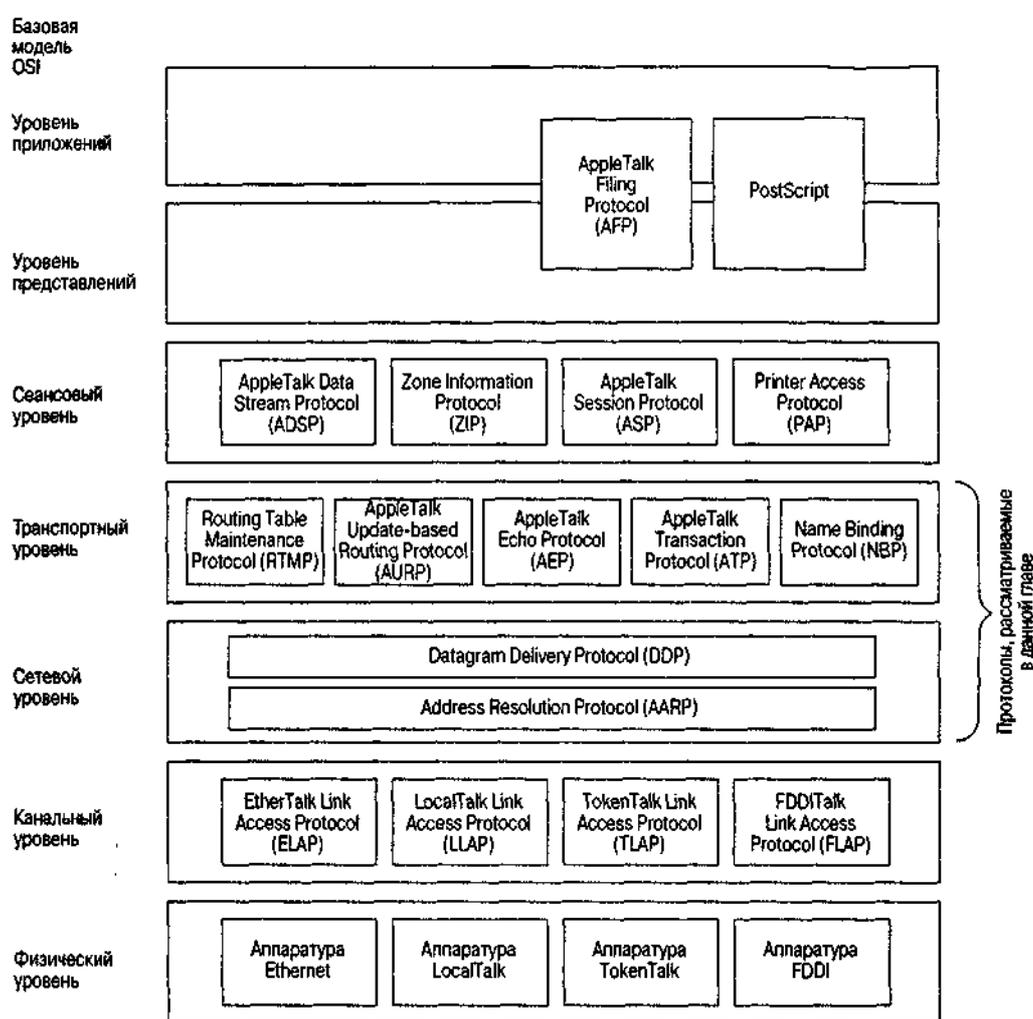
Рис. 5.1. Набор протоколов из состава протокола AppleTalk
