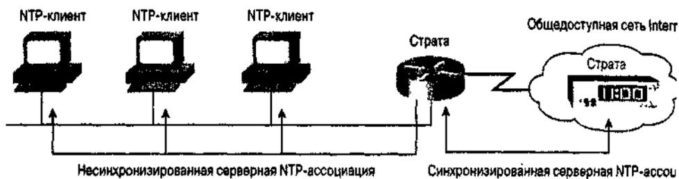
Рис. 7.3. Эти NTP-клиенты входят в серверную ассоциацию с устройством, работающим под управлением ОС IOS, которое синхронизируется с авторитетным источником времени общего пользования Internet
