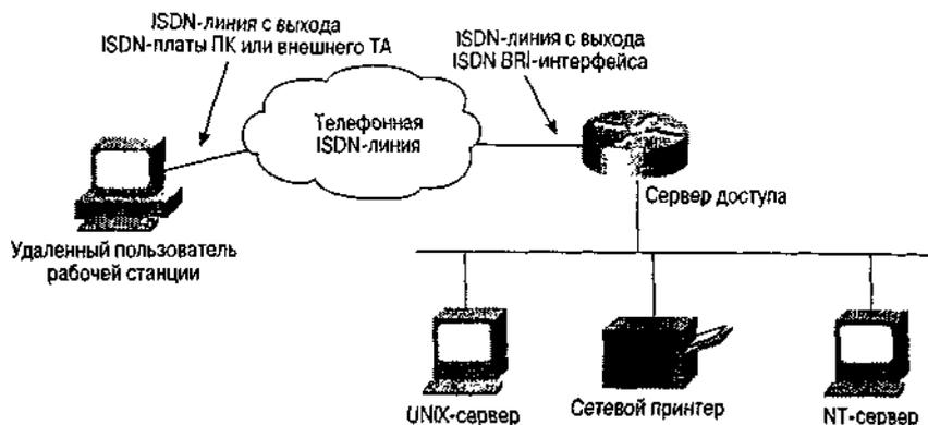
Рис. 4.10. Удаленный доступ к серверу доступа по коммутируемым каналам связи в ISDN-сети
