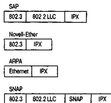
Рис. 6.2. Форматы инкапсуляции для протоколов канального уровня протокола IPX
