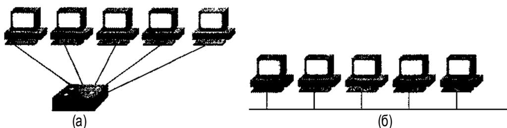
Рис. 3.2. Физическая (а) и логическая (б) топологии сегмента сети Ethernet
